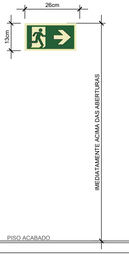
LUMINÁRIA DE SINALIZAÇÃO DE ABANDONO DE LOCAL COM SETA INDICATIVA DE SAÍDA S/ ESC.
